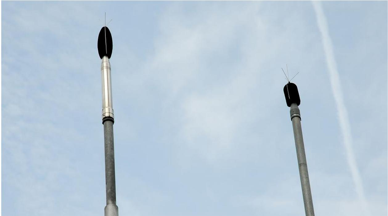
*Um den Einfluss von Fremdgeräuschen am Boden möglichst gering zu halten, werden die Mikrofone für die Fluglärmmessung an Masten montiert. (Quelle: UNH)*
