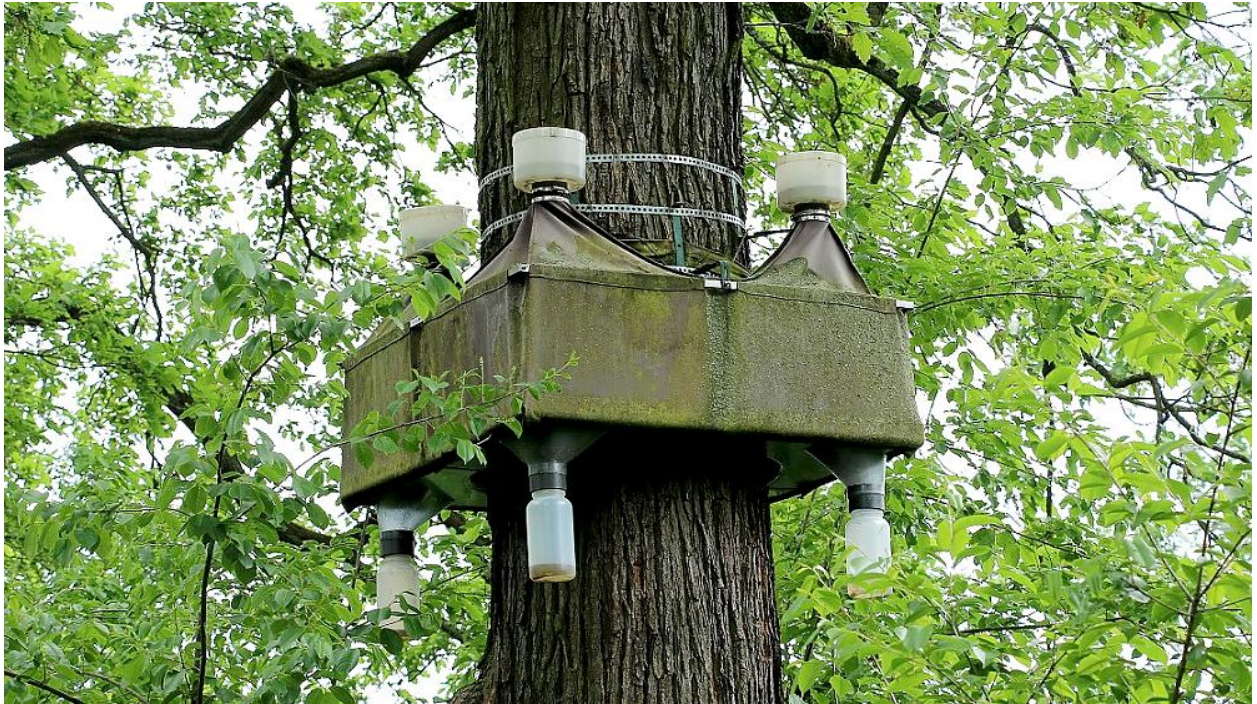
Stammeklektor zum Fangen von Käfern, Spinnen und Co. (Quelle: UNH)
